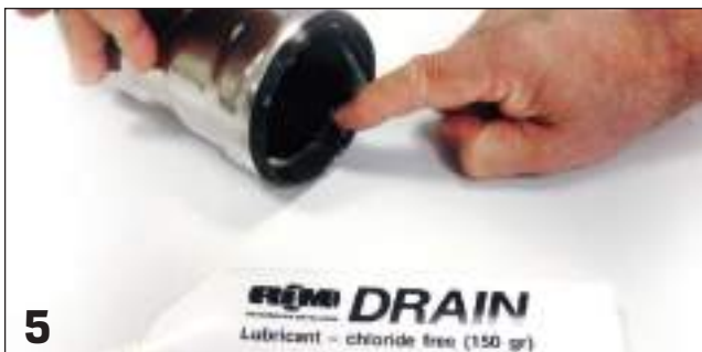
Lubrificazione zona interna guarnizione / Internal gasket lubrication
